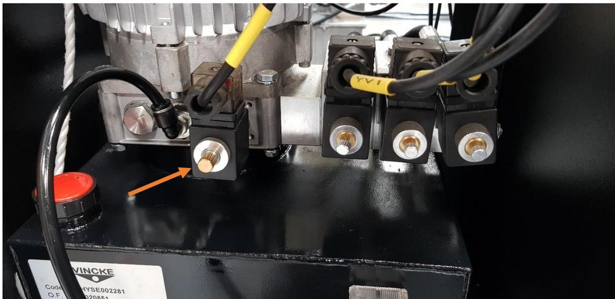
→ APPUYER ALTERNATIVEMENT OU EN MÊME TEMPS SUR LES DEUX BOUTONS DES ÉLECTROVANNES PONT GAUCHE ET DROIT
