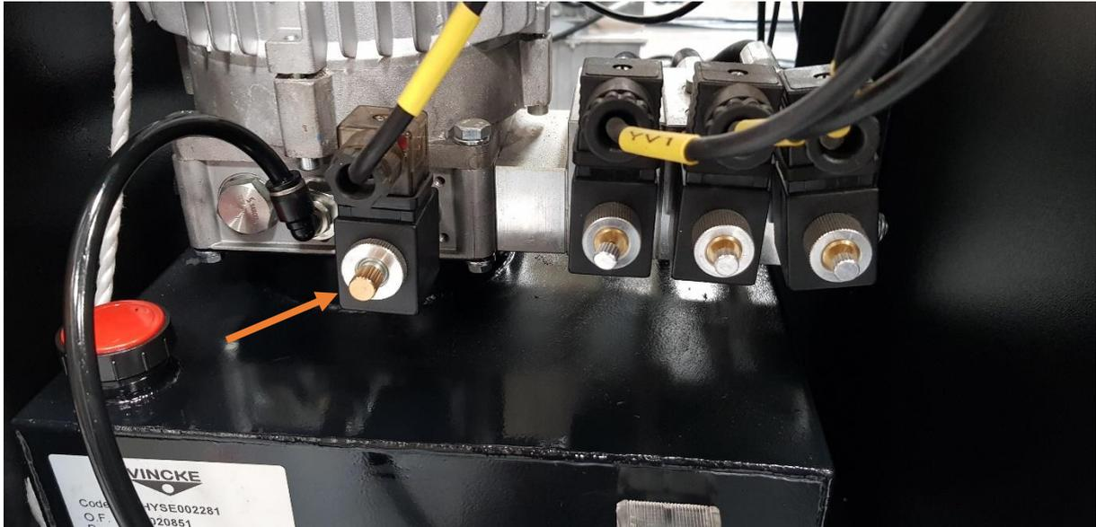
→ APPUYER SUR LE BOUTON DE L'ÉLECTROVANNE PONT AUXILIAIRE
